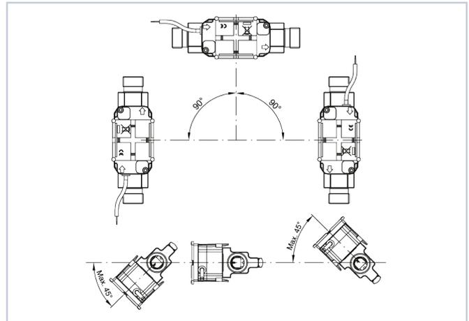
ULTRAFLOW® 54 peut aussi être tourné de  $\pm 90^\circ$  par rapport à l'axe de la conduite.
