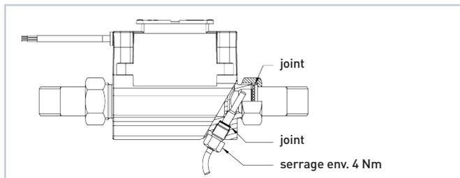
Compteur à bride avec un intégrateur MULTICAL® ou Pulse Transmitter monté sur un ULTRAFLOW®54.
