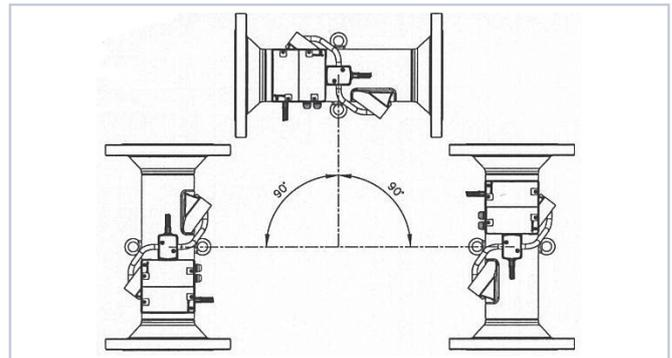
ULTRAFLOW® 54 peut aussi être tourné de  $\pm 90^\circ$  par rapport à l'axe de la conduite.
