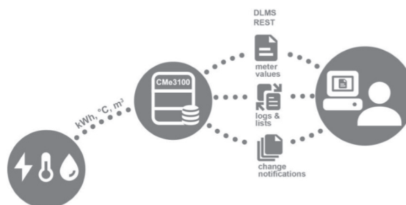
Ryc. 2: Integracja z bramką poprzez serwer DLMS / REST
