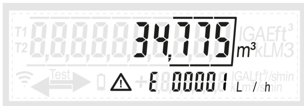
Rys. 19: Ostrzeżenie o pustym rurociągu widoczne podczas montażu przepływomierza
