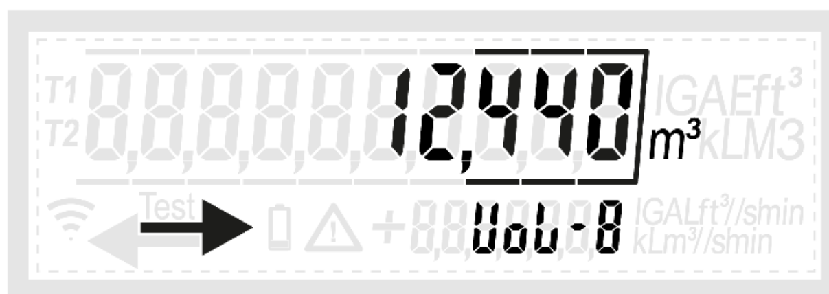
Rys. 21: Przykładowe wskazanie rejestrowanej objętości przepływu wstecznego na wyświetlaczu
