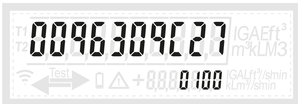
Rys. 24: Pierwsza sekwencja – przykład wskazania sumy kontrolnej oprogramowania wyświetlacza LCD (góra) i wskazania wersji (dół)
