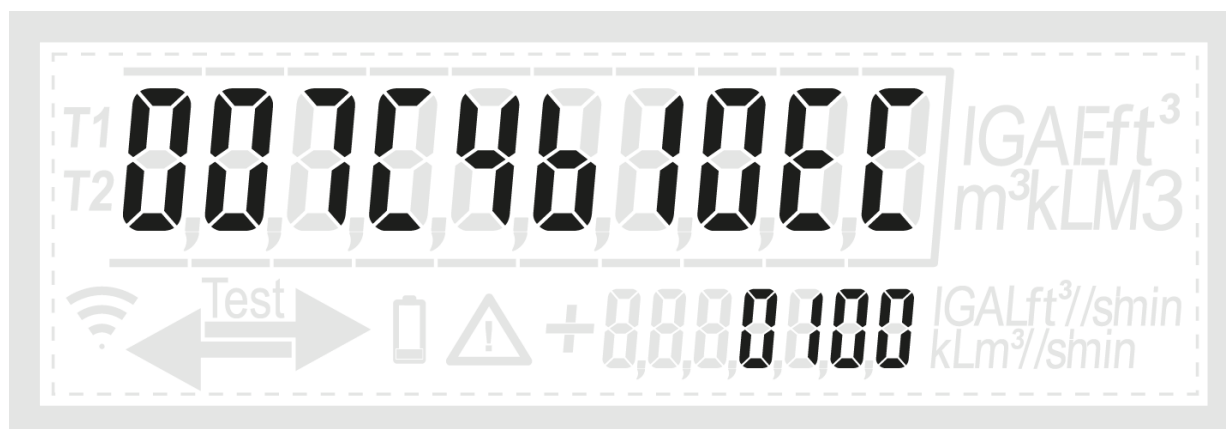
Rys. 23: Pierwsza sekwencja – przykład wskazania sumy kontrolnej oprogramowania metrologicznego (góra) i wskazania wersji (dół)
