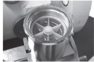
Fig. 5 | Serbatoio di contenimento dell'olio
