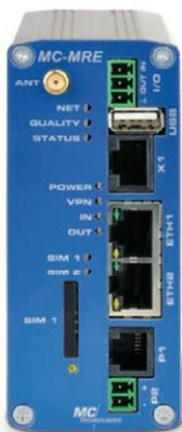
Als Datenprotokoll wird standardmäßig DSfG verwendet. Der serielle DSfG-Klasse A Bus kann an der Schnittstelle CH1 verbunden werden, um mehrere DSfG-fähige Geräte miteinander zu koppeln. Die neue Steckerform RJ45 wird mittels Adapter und neuem DSfG Sternverteiler an bestehende Technik adaptiert.
