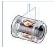
Durchflussmessung nach dem Faraday'schen Induktionsgesetz
