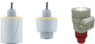
Le capteur de niveau à ultrasons fonctionne en alimentant un transducteur piézoélectrique avec une impulsion électronique. Cette impulsion crée une onde de pression qui se propage à la surface de l'écoulement et est partiellement réfléchi vers le transducteur. Le temps de parcours du signal vers la surface de l'écoulement et retour est enregistré. La distance réelle est calculée en connaissant la vitesse du son sur place, qui est corrigée par un capteur de température intégré.
